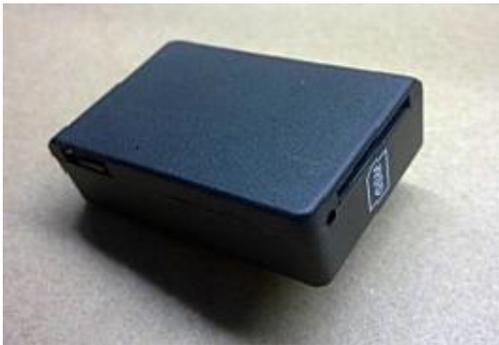
Вы являетесь счастливым владельцем Слушающего GSM-устройства MicroBug200, которое совместимо с GSM-сетями, работающими в следующих частотах 900 МГц, 1800 МГц, 1900 МГц и обладает длительным периодом работы в режиме ожидания.
